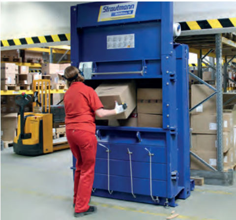
Grande apertura di alimentazione La grande apertura permette di inserire grandi cartoni.
